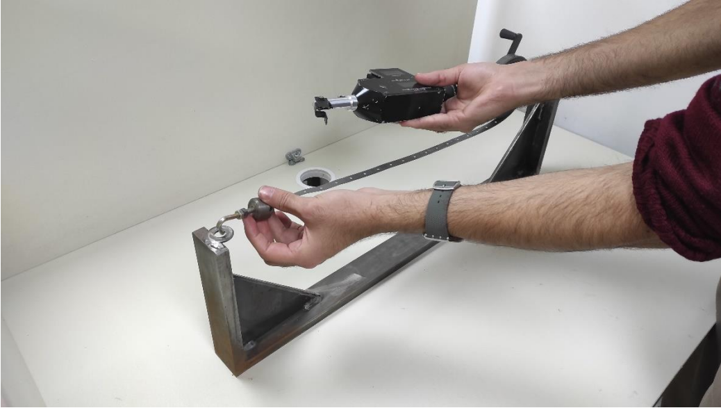
Şekil 3. Çerçeve referanslama esnasında kancaların geçirilmesi
