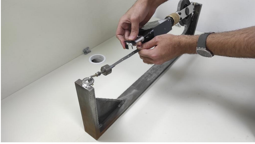
Şekil 4. Çerçeve üzerinde gerili şerit üzerine en yakın pinin geçirilmesi – uygun koşul
