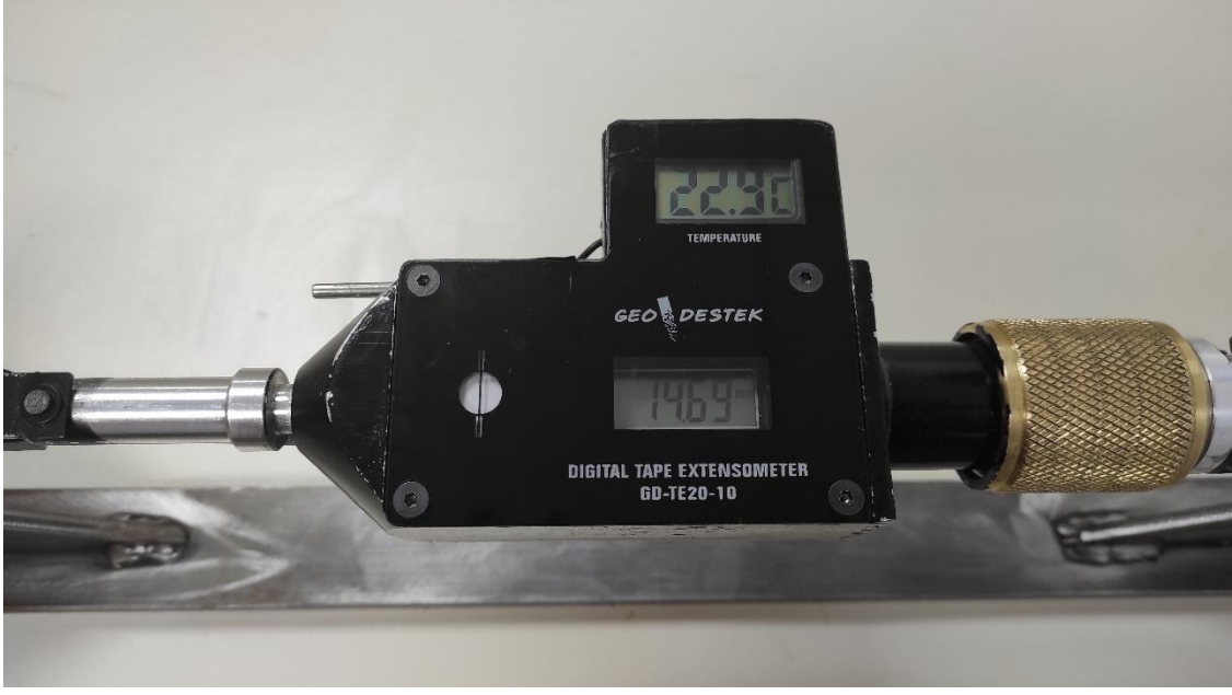
Şekil 9. Referans gerginliğe ayarlanmış şerit ekstansometre
