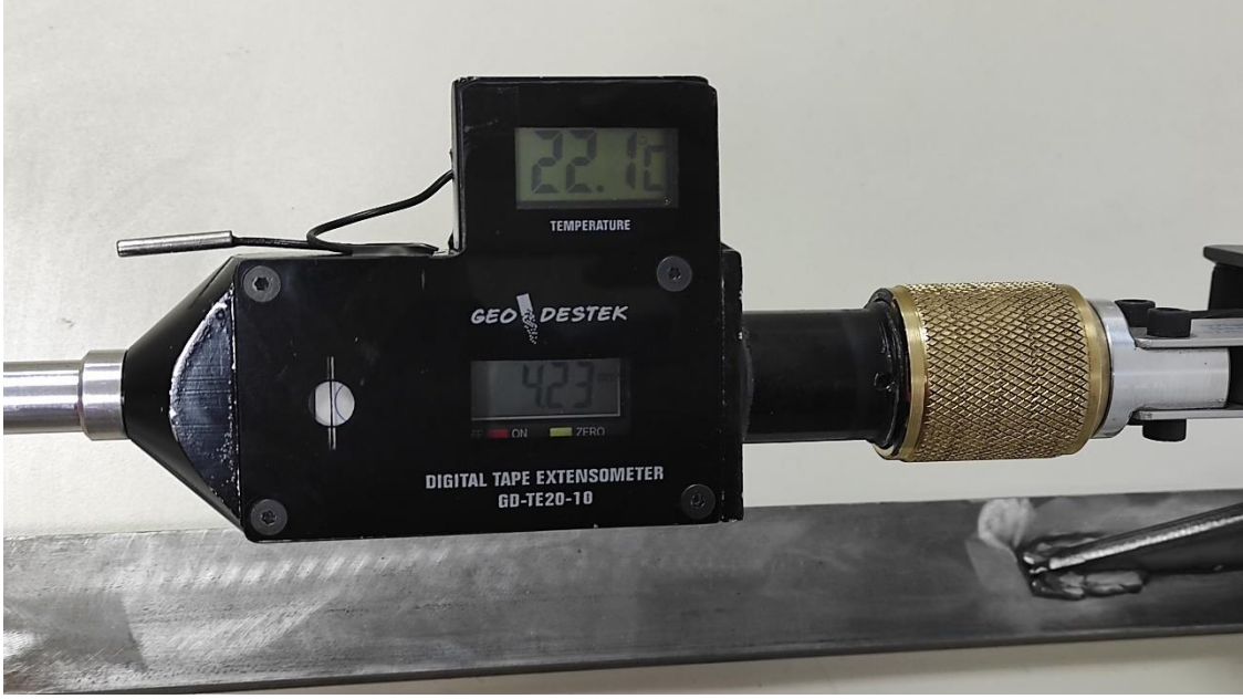
Şekil 8. Kademeli olarak gerdirilmeye başlanan şerit ekstansometre
