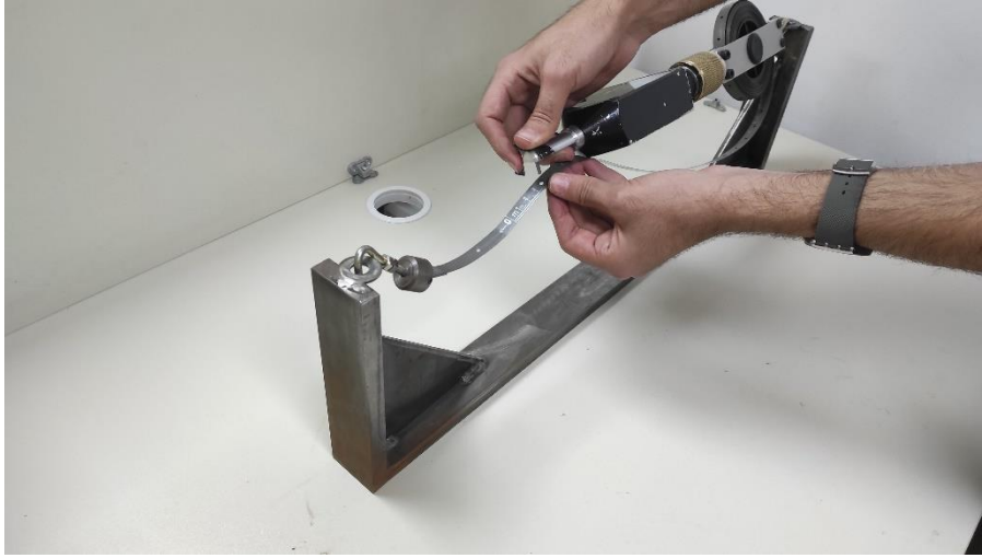
Şekil 5. Çerçeve üzerinde gerili şerit üzerine en yakın pinin geçirilmesi – uygun olmayan koşul
